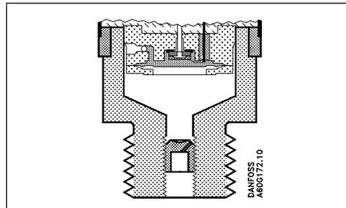
Die Viskosität des Mediums hat nur geringen Einfluß auf die Ansprechzeit des Druckmeßumformers. Selbst bei einer Viskosität von 100 cSt wird die Ansprechzeit von 4 ms nicht überschritten.
