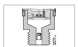
Les coups de bélier, pics de pression et cavitation se produisent dans les systèmes exposés aux fortes variations de pression (fermeture rapide d'une vanne, arrêt ou marche de pompe par exemple). Ce problème qui se produit aussi bien en entrée qu'en sortie, surgit même à des pressions relativement basses.
