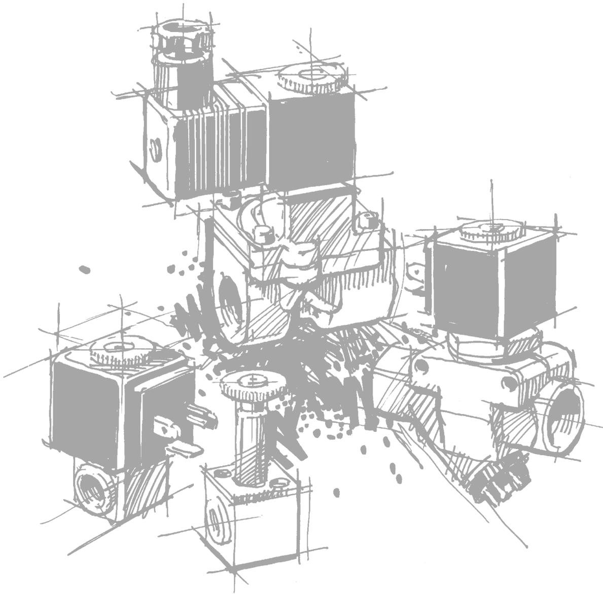
Magnetventile mit eingebautem Filter
